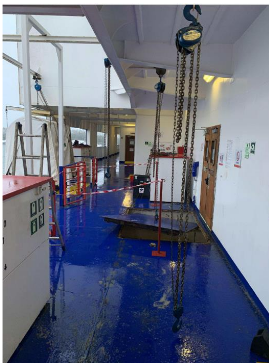
Figur 1. Den upplyfta luckan och hålet som personen föll ned igenom. Foto: Polisen
