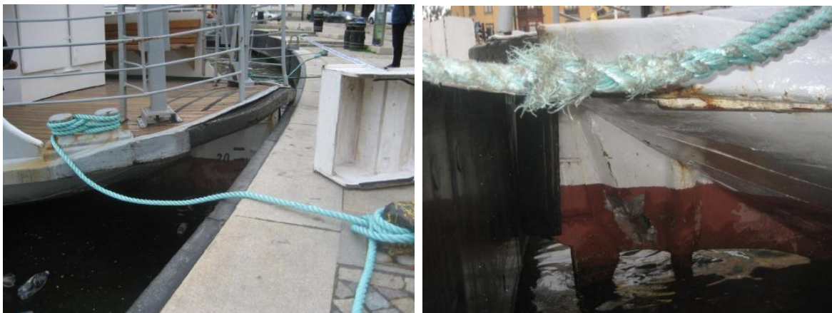
Fartyget förtöjt efter olyckan. Till vänster syns hur trädäcket tryckts upp i centerlinjen. Bilden till höger visar skadorna på förstäven.
