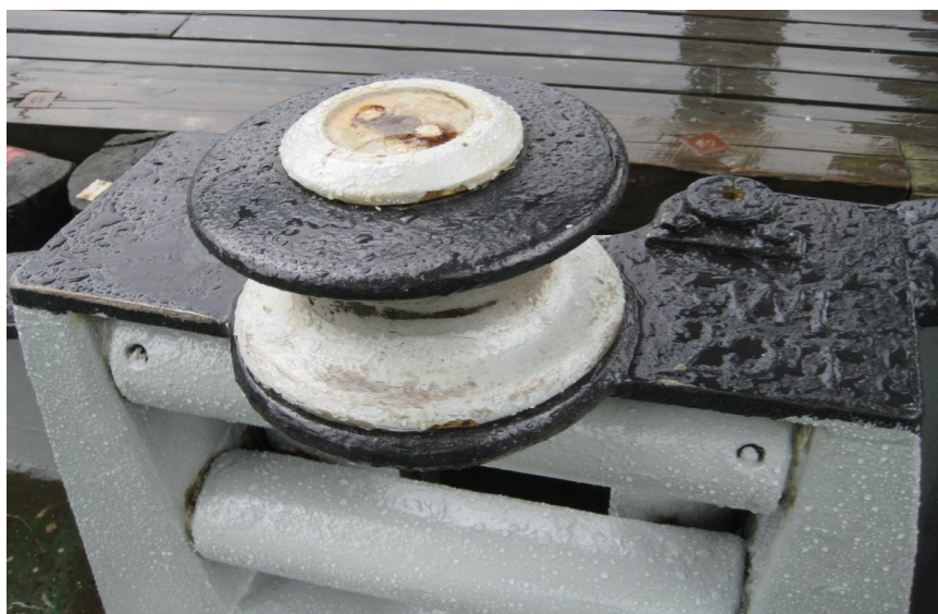
Motsvarande brytrulle på babordssidan. Till höger om rullen syns märkningen SWL 9,0T.
