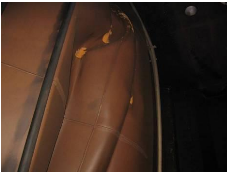
Bild 8 Bågnat skott mellan lasttankarna 2:an babord och styrbord
