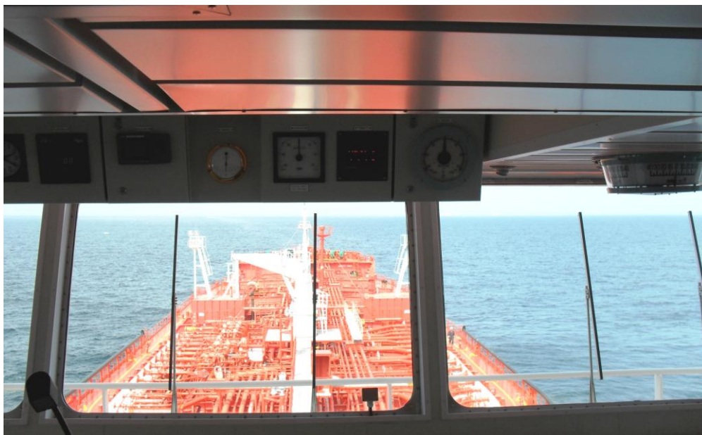
Vy över förkant av bryggan med instrumenten för roderläge och girhastighet
