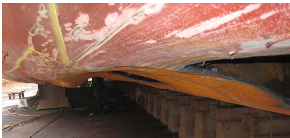
Skada i dubbelbotten, styrbord sida
