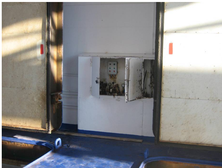
Bild: Hydraulreglage för riggning av traversens balkar samt manövrering av luckor
