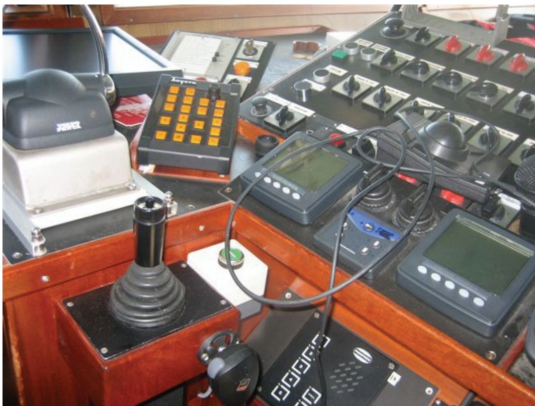
Bild Styrpinne med tryckknapp för i- och urkoppling av automatstyrningen
