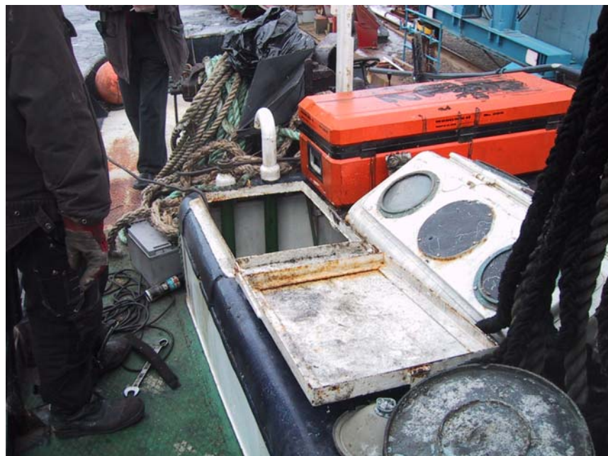
Figur: Nedgångslucka till maskinrummet.
