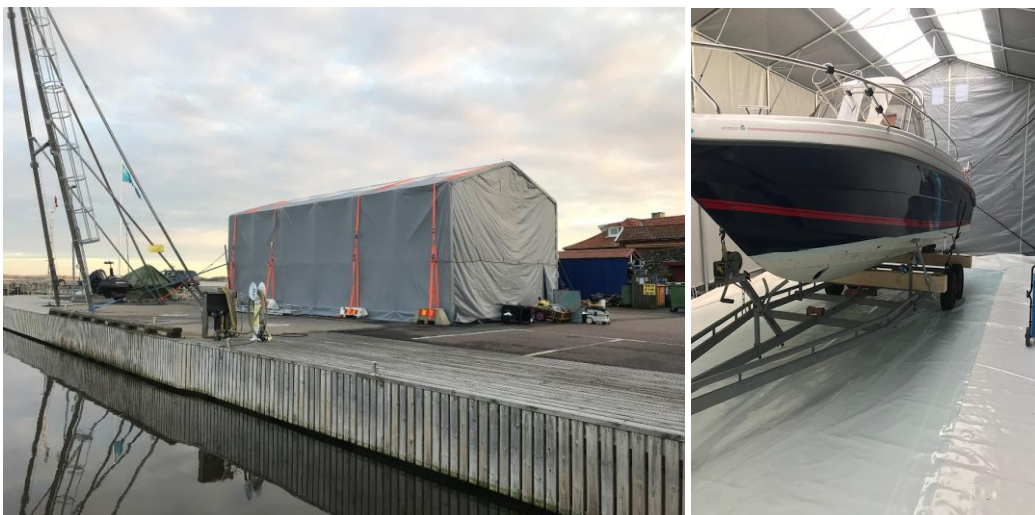
Figur 1. Experimenthall i hamnmiljö (vänster). Uppställd båt på marktäckning (ljusblå plast) och vit presenning som representerar yttre miljö (höger).
