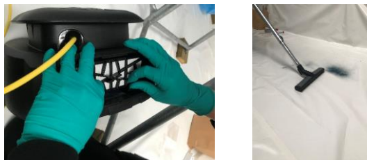
Figur 2. Provtagning (dammsugning) av slipdamm från båtbottnfärg (vänster) och montering av HEPA-filter i aktuell provtagningsdammsugare (höger).
