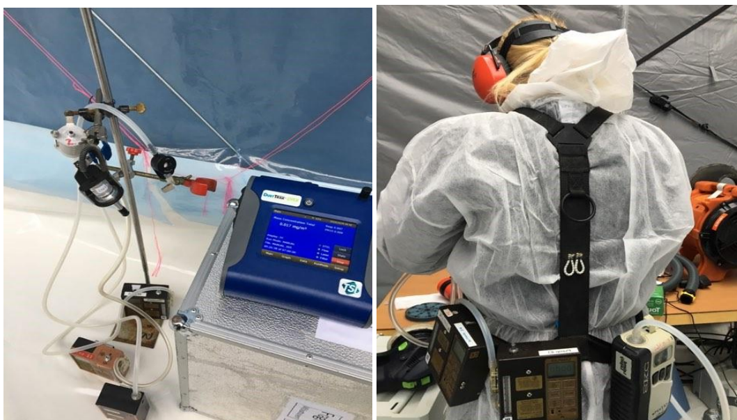
Figur 3. Till vänster syns utrustning för stationär mätning av spridning till miljön (Dust Trak), till höger visas utrustning för exponeringsmätning vid blästring.
