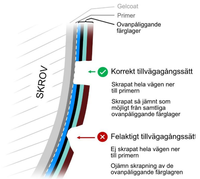
Figur 3 En korrekt skrapning når hela vägen ned till primern på gelcoaten (vit streckad linje), med en jämn skrapning från alla färglager.
