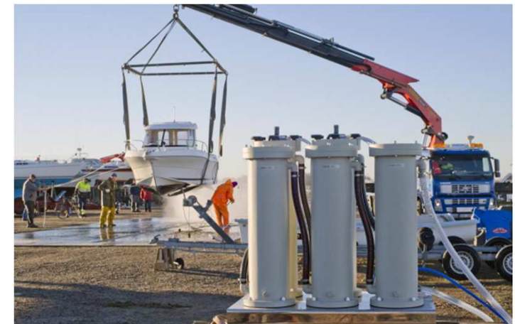
Miljöanpassat båtupptag i Träslövsläges båtsällskap. Högtryckstvättning över spolplatta med grovrensrännor samt efterföljande reningssteg med kolfilter. Bild: Lennart Benson
