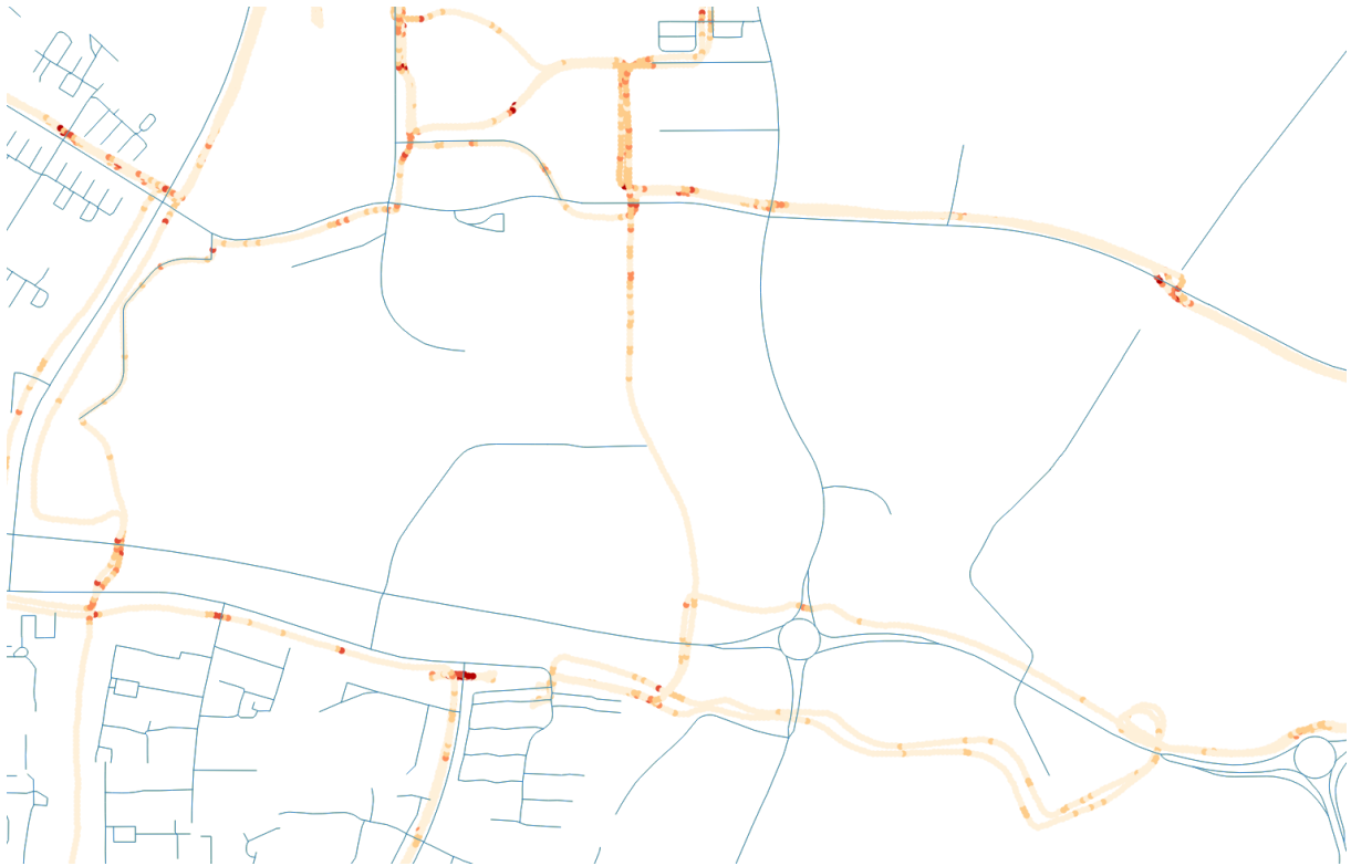
Figur 8 Karta med mätdata från accelerometer monterad på en cykel. Röda punkter betyder hög acceleration, gul markering cykelbana och blå bilväg. Bild: Leif Sjögren.
