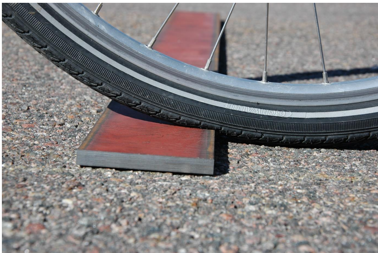
Figur 9 Cykeldäcket när det passerar en utlagd metallribba. Foto: Leif Sjögren, VTI.
