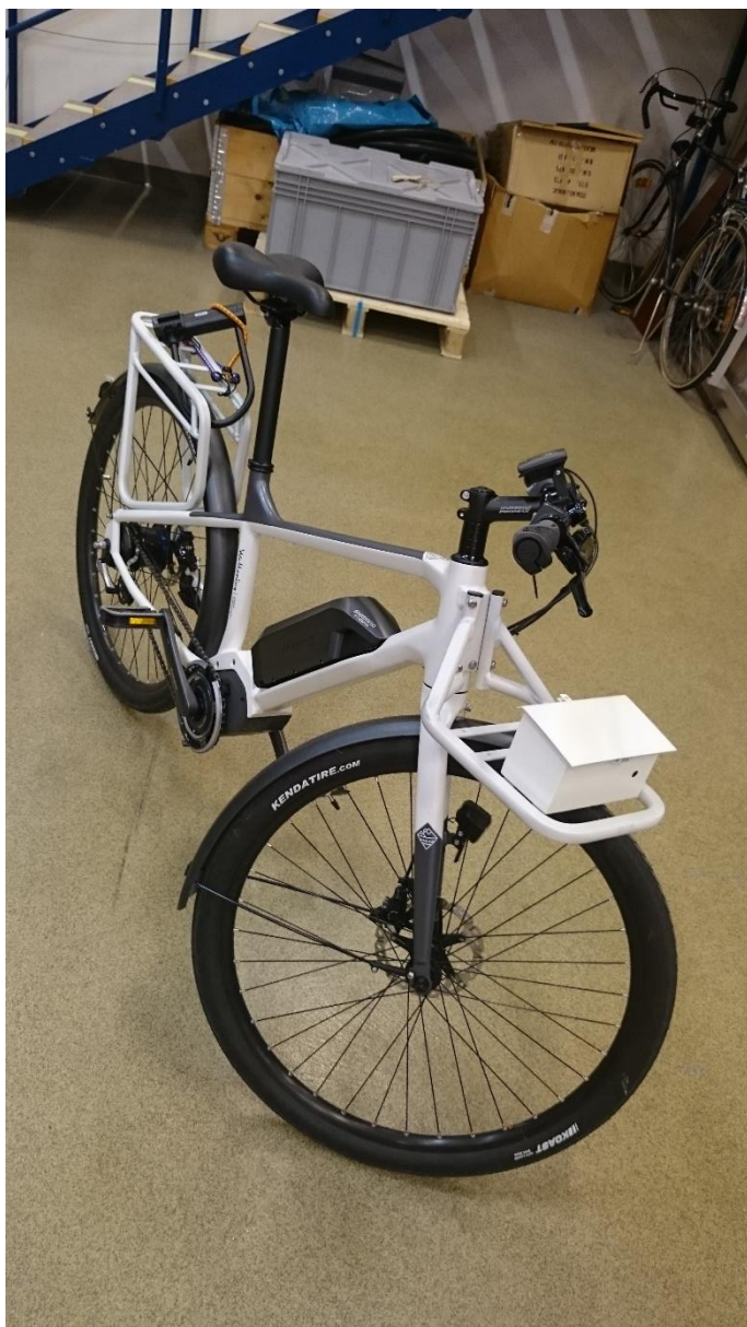
Figur 7 Mätcykel; mätutrustning är monterad i boxen på den främre pakethållaren.
