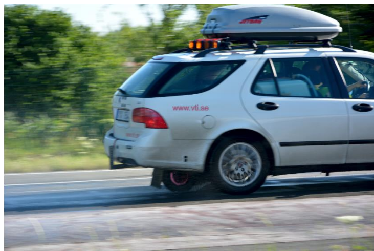
Figur 1 Den nuvarande svenska mätmetoden, Surface Friction Tester (SFT). Teckning från Saab Friction Tester manual, foto: Leif Sjögren.
