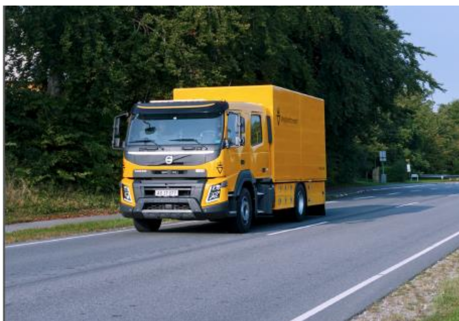
Figur 28 VIAFRIK, den nya danska friktionsmätutrustningen. Foto: Danish Road Directorate.
