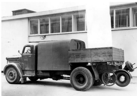
Figur 14 Den första skiddometermätaren BV1 byggd av VTI 1949. Foto: från VTI:s arkiv
