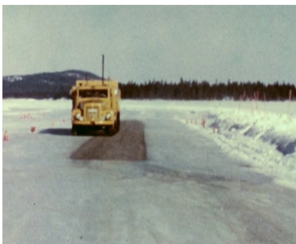
Figur 2. Bildruta från filmdokumentation om mätningarna för split friction och antilåssystem i Arjeplog 1981.
