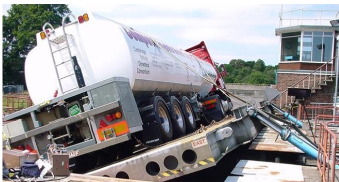
Figur 15 Test av SRT hos en semitrailer-tankbil Bildkälla: CVDC
