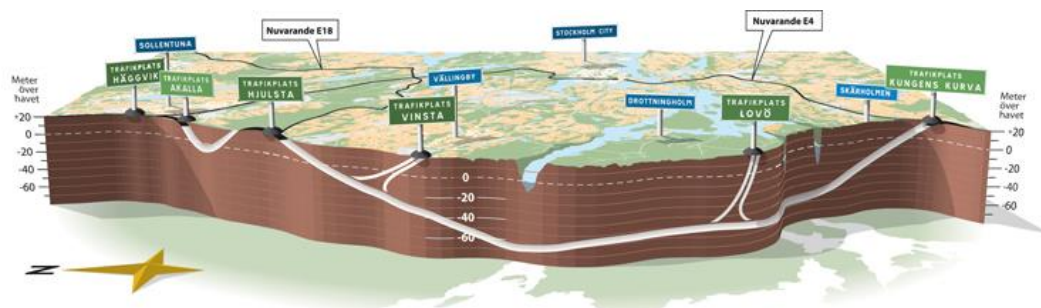
Figur 5. Tunnelprofil för E4 Förbifart Stockholm. (Källa: Trafikverket, 2018 b .)
