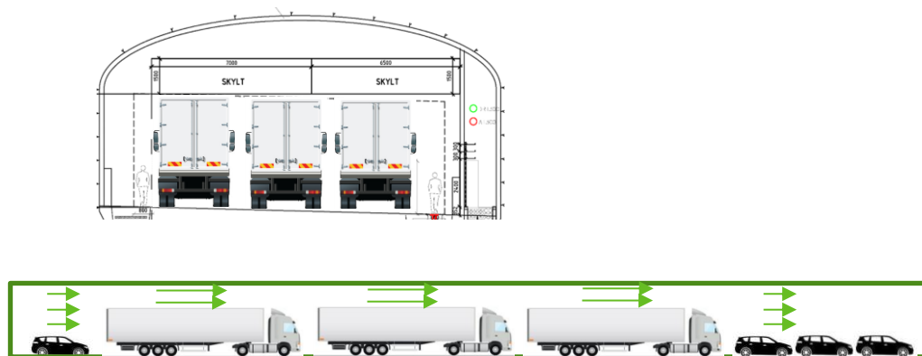
Figur 7. Övre figur: tre lastbilar i bredd i en kö. Nedre figuren: Höga fordon i en kö minskar den fria arean i tunnelsektionen och lufthastigheten kring fordonen ökar för ett givet luftflöde genom tunneln. Källa: WSP.
