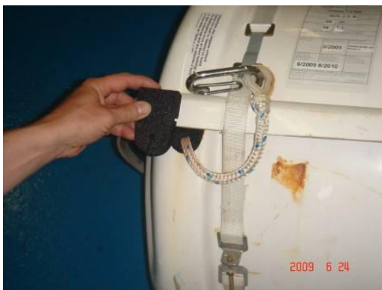
Bild 7. Packning med utlösninglina
