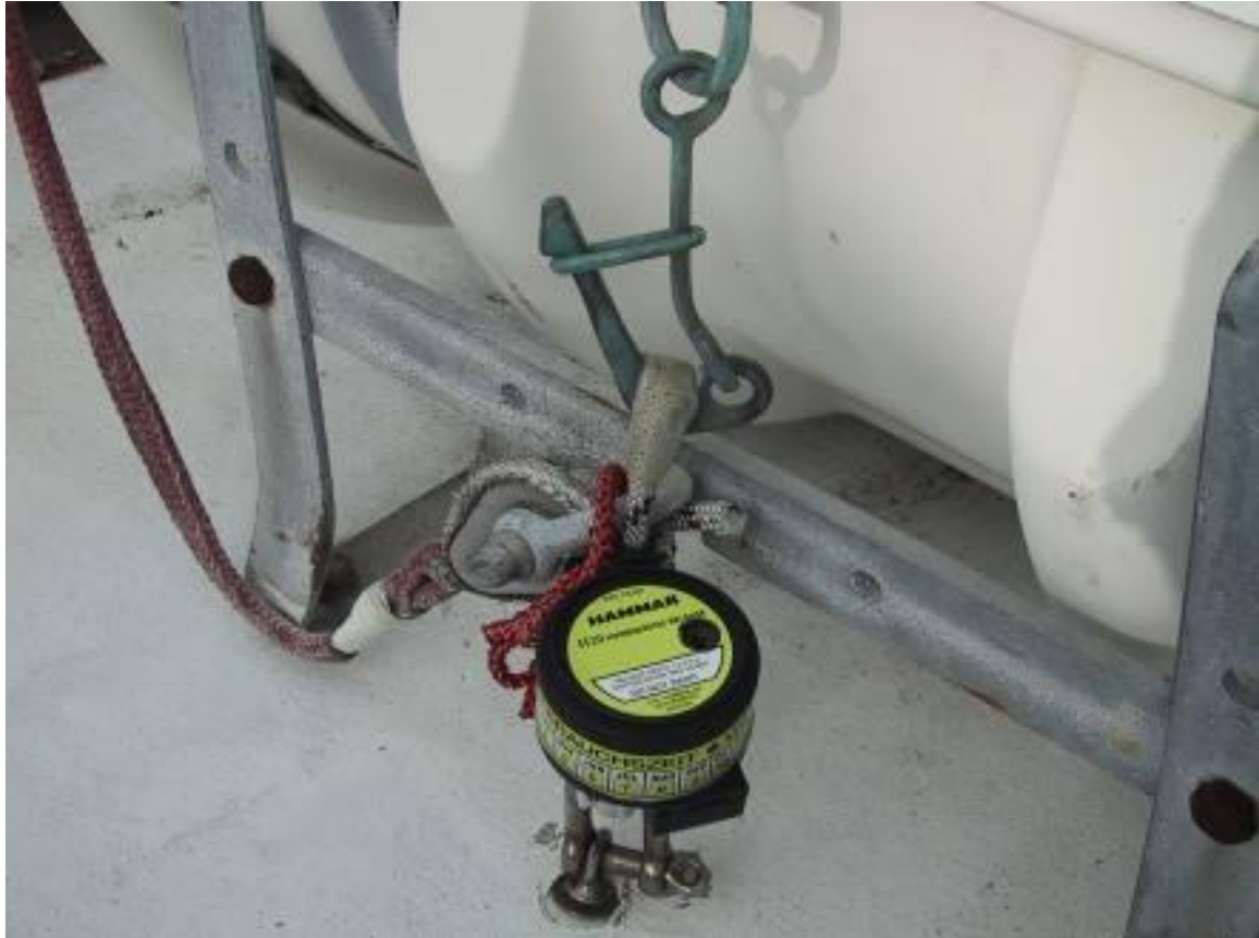
Bild 9. Sliphake som måste klämmas ihop för att lossöra flotten
