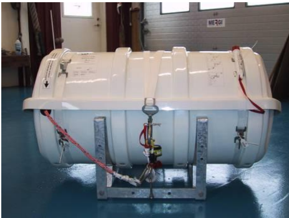
Bild 1. Flottecontainer i sin vagga med hydrostat i mitten och utlösningens linan till vänster
