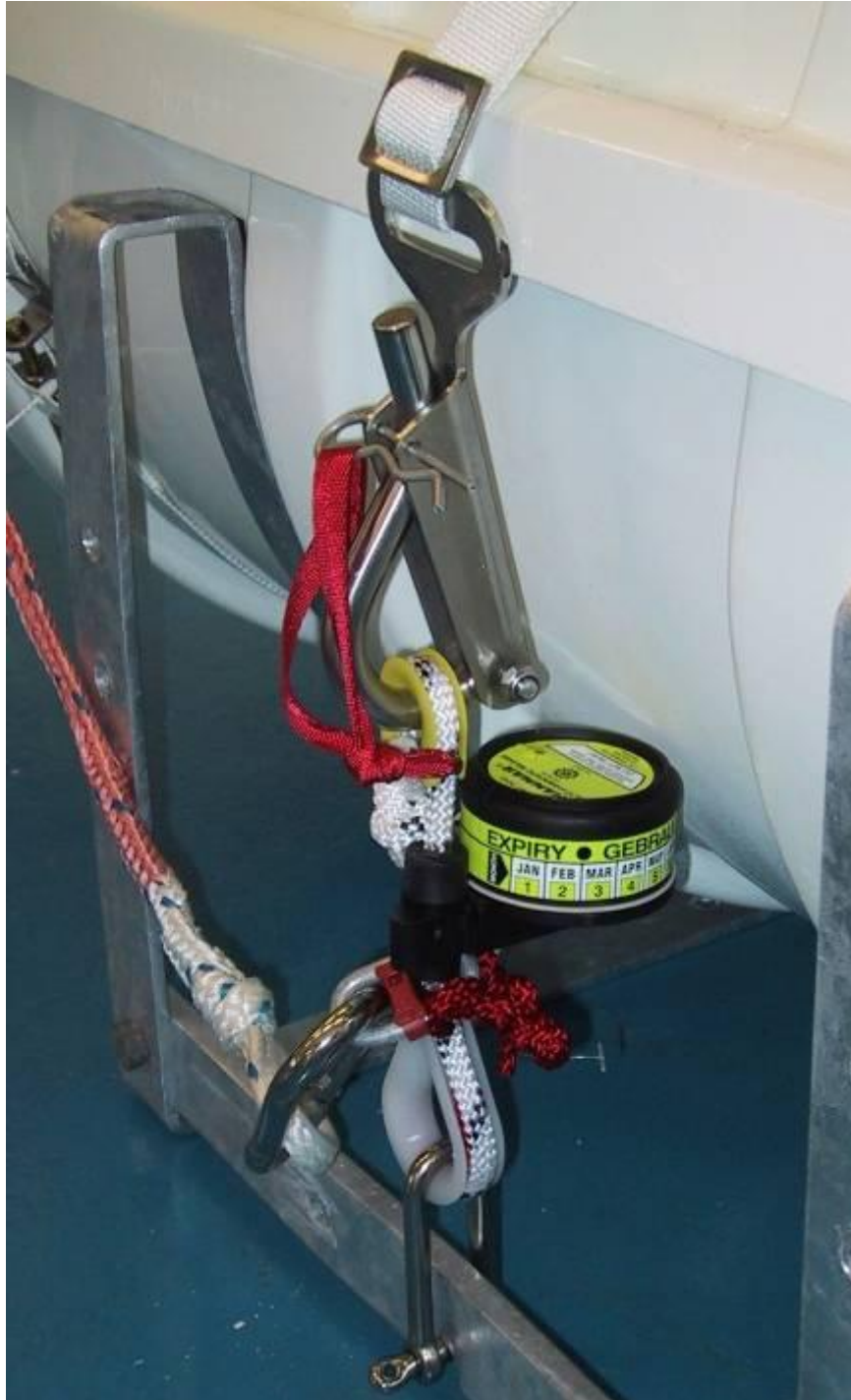
Bild 5. Hydrostat (gul dosa); "weak link" mellan schackel och sliphake; utlösninglina till vänster
