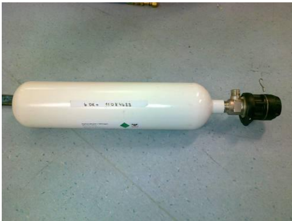
Bild 3. Gasflaska med den vajer som är kopplad till utlösningsslinan (till höger)
