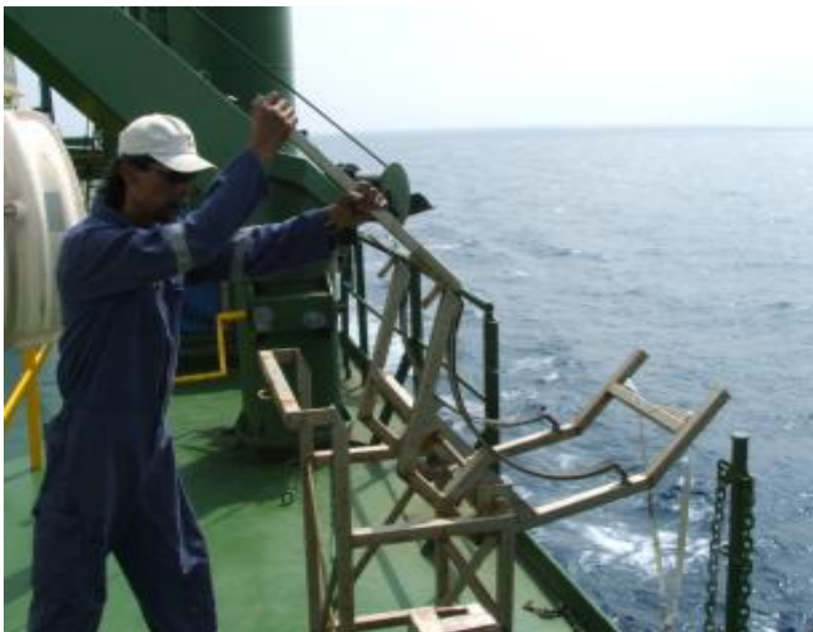
Bild 12. Flotten sjösatt med hjälp av hävarm
