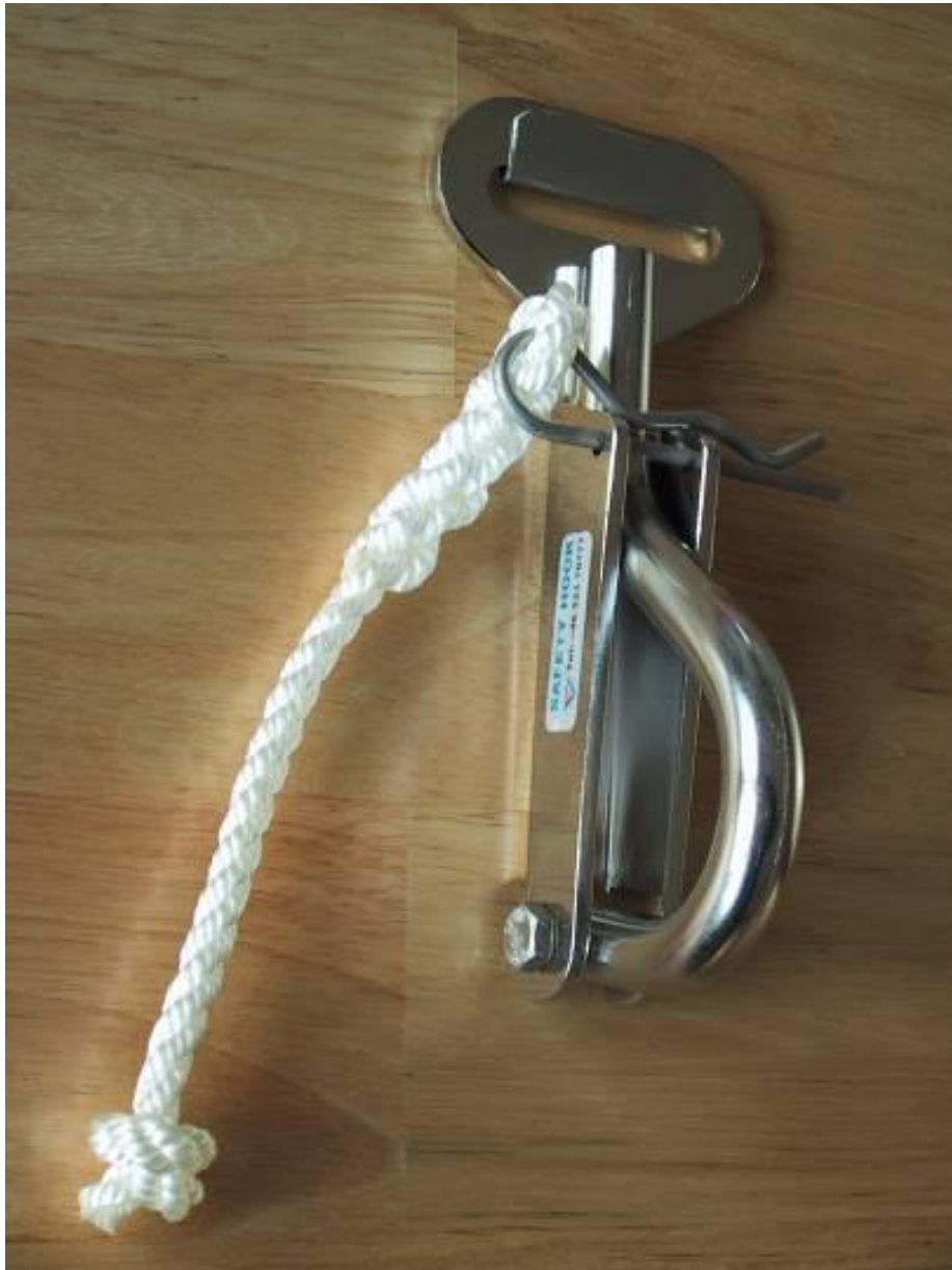
Bild 10. Sliphake som med ett lätt ryck i låssprinten öppnar sig oavsett hur tajt surrningen är anbragd
