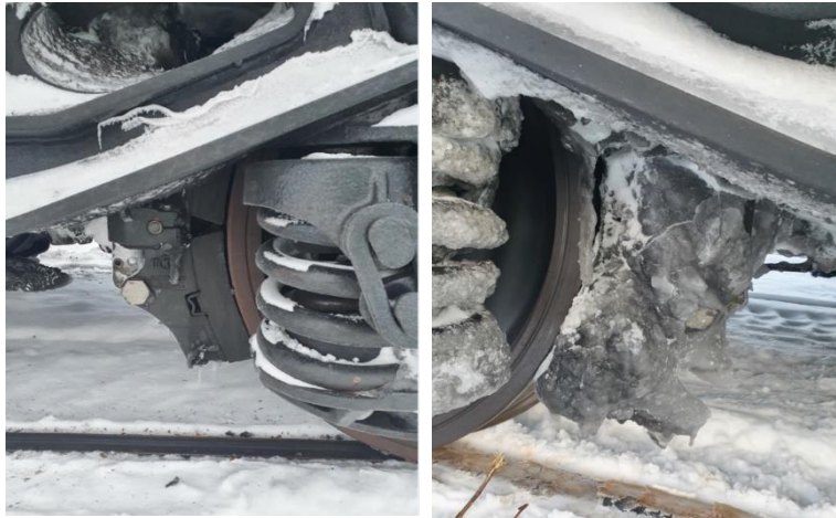
Figur 1. Skillnaden i nedisningsgrad mellan K-bromsblock J822 (organiskt) med kraftig nedisning och C333 (sintrat) med obetydlig nedisning. Vagnarna har gått i samma tåg. Fotot är taget efter en tomkörning på ca 200 km.
