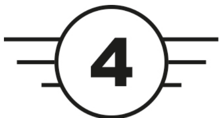
Figur 7 Så här ser märkningen ut på en C4-drönare
