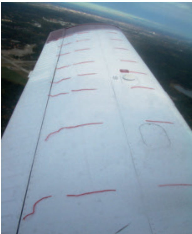
Nedan: Högre anfallsvinkel. De bakersta tofsarna visar att avlösningen börjat.
