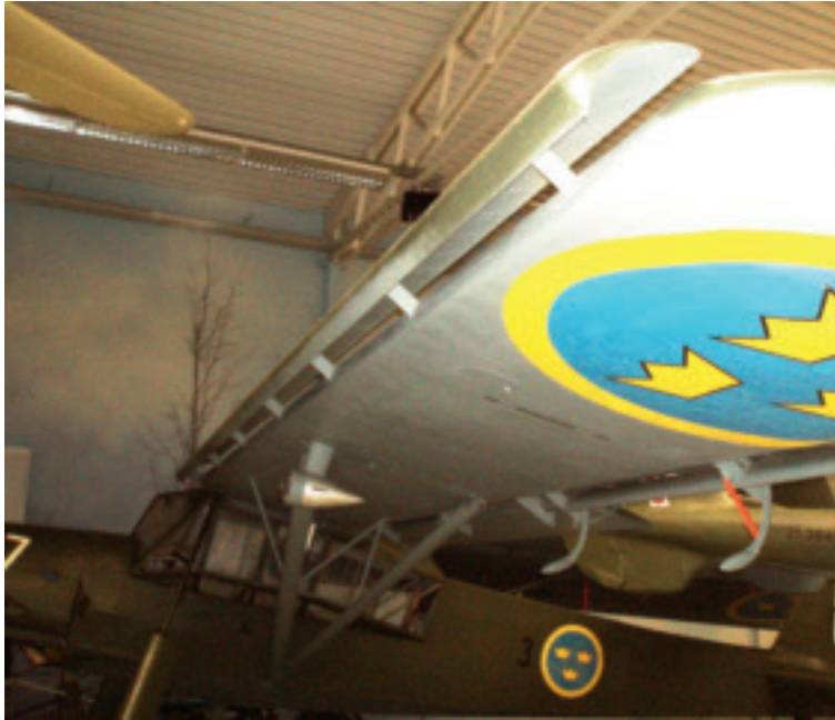
Det finns även exempel på fast spaltvinge (Fieseler Storch).
